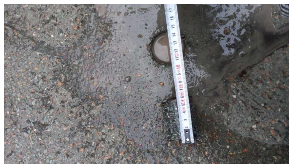
Prélèvement - P004 : ZONE LOGISTIQUE / EXTERIEURS / VOIRIE - Enrobé bitumineux- (Absence d'amiante)
