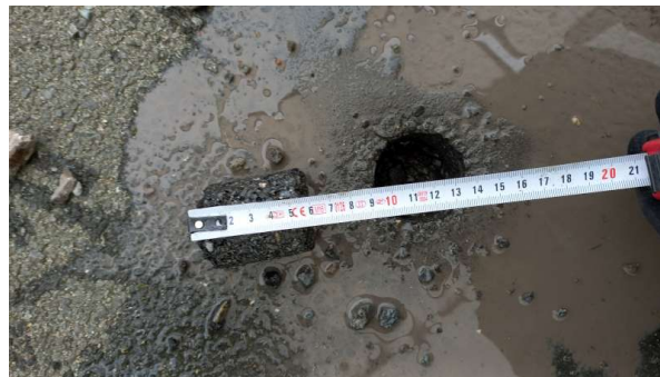
Prélèvement - P020 : ZONE LOGISTIQUE / EXTERIEURS / VOIRIE - Enrobé bitumineux- (Absence d'amiante)
