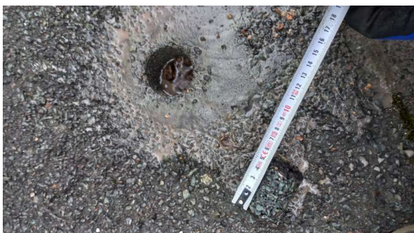
Prélèvement - P005 : ZONE LOGISTIQUE / EXTERIEURS / VOIRIE - Enrobé bitumineux- (Absence d'amiante)
