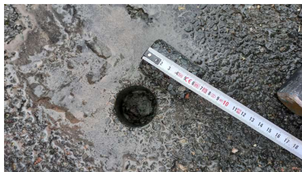
Prélèvement - P010 : ZONE LOGISTIQUE / EXTERIEURS / VOIRIE - Enrobé bitumineux- (Absence d'amiante)
