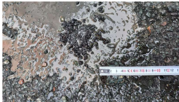
Prélèvement - P014 : ZONE LOGISTIQUE / EXTERIEURS / VOIRIE - Enrobé bitumineux- (Absence d'amiante)
