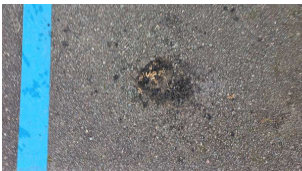
Prélèvement - P021 : ZONE LOGISTIQUE / EXTERIEURS / VOIRIE - Enrobé bitumineux- (Absence d'amiante)
