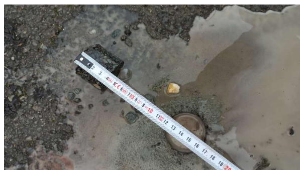
Prélèvement - P018 : ZONE LOGISTIQUE / EXTERIEURS / VOIRIE - Enrobé bitumineux- (Absence d'amiante)
