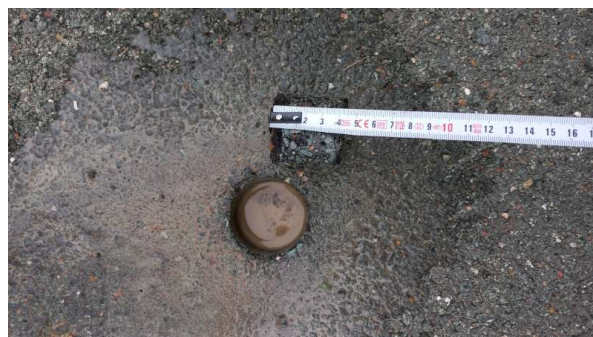
Prélèvement - P006 : ZONE LOGISTIQUE / EXTERIEURS / VOIRIE - Enrobé bitumineux- (Absence d'amiante)
