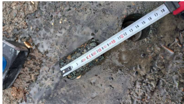
Prélèvement - P002 : ZONE LOGISTIQUE / EXTERIEURS / VOIRIE - Enrobé bitumineux- (Absence d'amiante)
