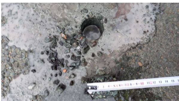
Prélèvement - P011 : ZONE LOGISTIQUE / EXTERIEURS / VOIRIE - Enrobé bitumineux- (Absence d'amiante)
