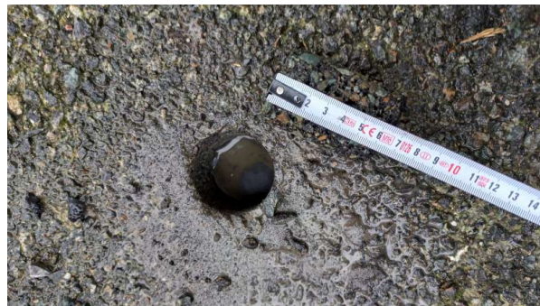
Prélèvement - P008 : ZONE LOGISTIQUE / EXTERIEURS / VOIRIE - Enrobé bitumineux- (Absence d'amiante)
