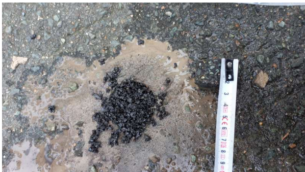
Prélèvement - P025 : ZONE LOGISTIQUE / EXTERIEURS / VOIRIE - Enrobé bitumineux- (Absence d'amiante)
