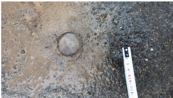
Prélèvement - P019 : ZONE LOGISTIQUE / EXTERIEURS / VOIRIE - Enrobé bitumineux- (Absence d'amiante)
