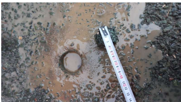
Prélèvement - P003 : ZONE LOGISTIQUE / EXTERIEURS / VOIRIE - Enrobé bitumineux- (Absence d'amiante)
